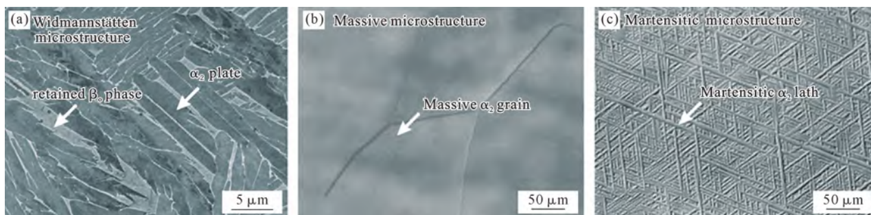
图 4 不同冷却速率下由 \beta \rightarrow \alpha 相变形成的微观组织: (a) 魏氏组织 (Ti-44Al-3Mo-0.1B 合金); (b) 块状组织 (Ti-42Al-5V 合金); (c) 马氏体组织 (Ti-42Al-10V 合金) [18,37]
