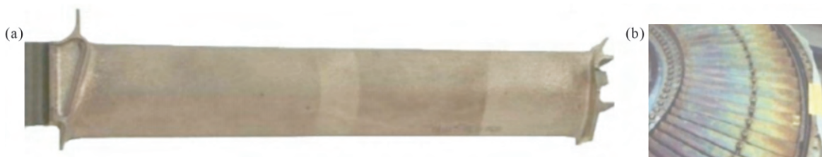
图11 GE系列航空发动机中TiAl合金低压涡轮叶片的应用实例:(a) GENx发动机铸造4822合金低压涡轮叶片;(b) GE CF6试验发动机中使用的TiAl LPT叶片装配照片 [3]
