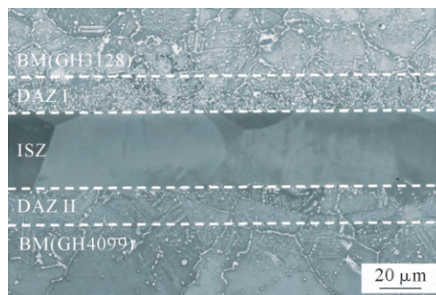
图 4 GH4099/GH3128 在 1 120 °C-60 min 下获得的 TLP 扩散焊接接头形貌
