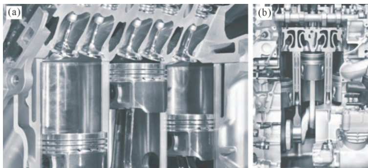
图 13 气缸套:(a) 干式气缸套;(b) 湿式气缸套
