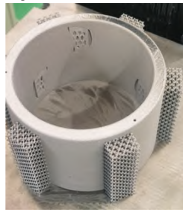
图 14 基于 SLM 技术打印新型结构轴承样件
