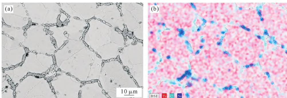
图 4 SC-6:4 复 合 材 料: (a) 显 微 组 织; (b) Si 元 素 分 布
