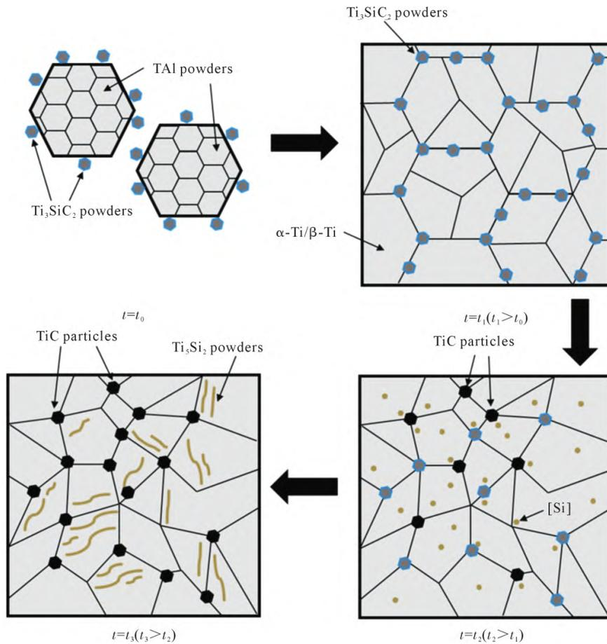
图 6 Ti-Ti<sub>3</sub>SiC<sub>2</sub>-Si 体系微观组织演变过程
