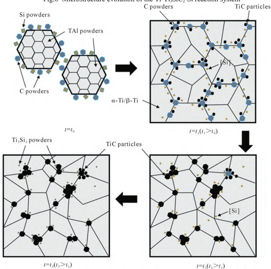
图 7 Ti-C-Si 体系微观组织演变过程
