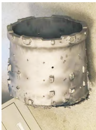
图5 整理后的油箱骨架筒形结构铸件
