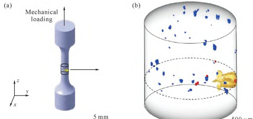
图2 L-PBF制备Ti6Al4V的缺陷分布:(a)Ti6Al4V试样取向示意图;(b)裂纹分布X-CT三维形貌重构结果<sup>[31]</sup>
