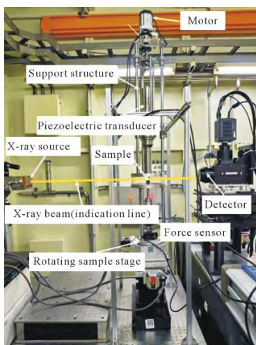
图 12 基于上海 SSRF 光源线站的原位超声疲劳测试系统<sup>[92]</sup>
