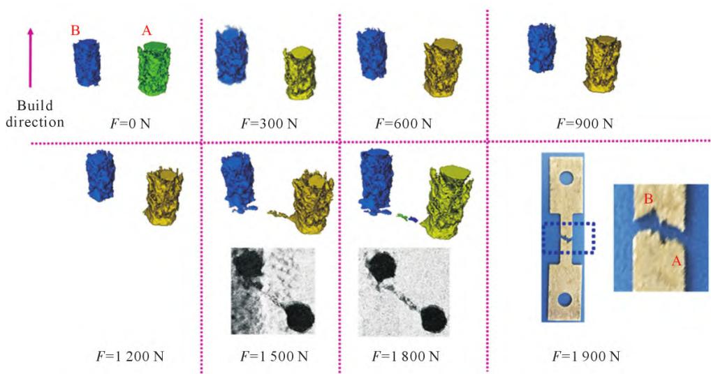
图 9 X-CT 原位表征通孔损伤演变<sup>[86]</sup>
