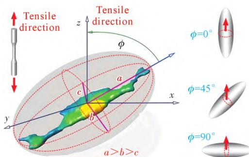
图 10 缺陷的等效椭球模型<sup>[89]</sup>
