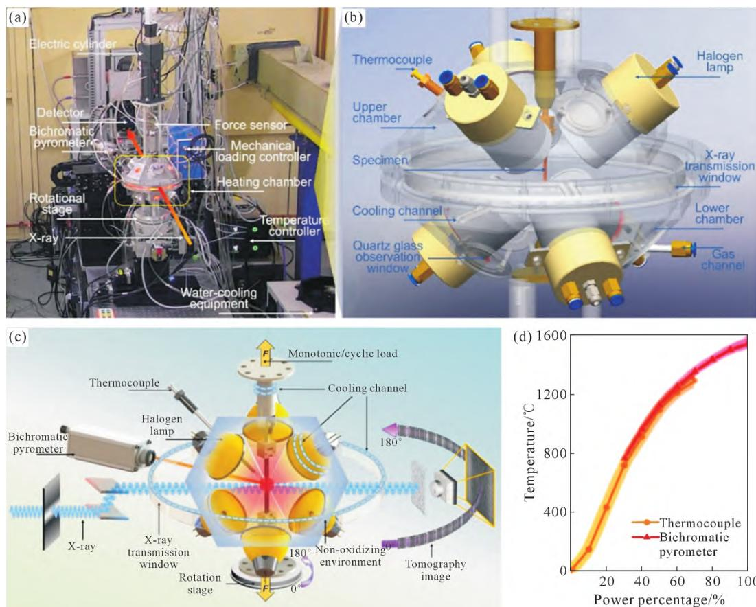
图 14 自主研发的多场耦合原位单调/循环加载装置(兼容高分辨 X 射线表征技术):(a) 上海光源运行中的高温原位测试装置实景;(b) 热-力耦合原位加载测试系统与断层扫描端站的工作原理示意图;(c) 加热腔体三维结构透视图;(d) 样品标距区温度随输入功率变化的特性曲线<sup>[100]</sup>
