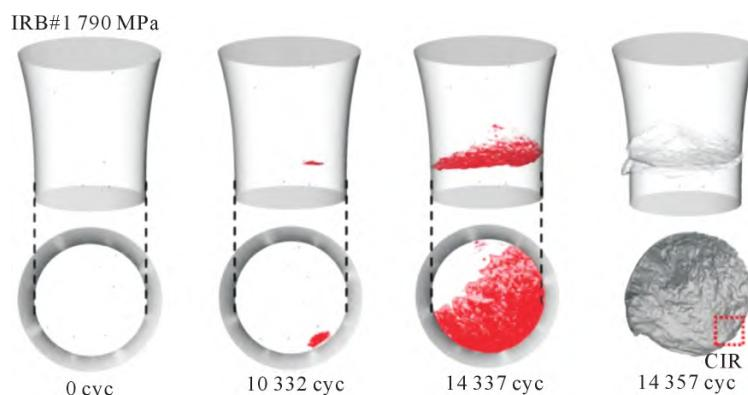
图 13 原位 RBF 测试单裂纹的三维渲染<sup>[95]</sup>
