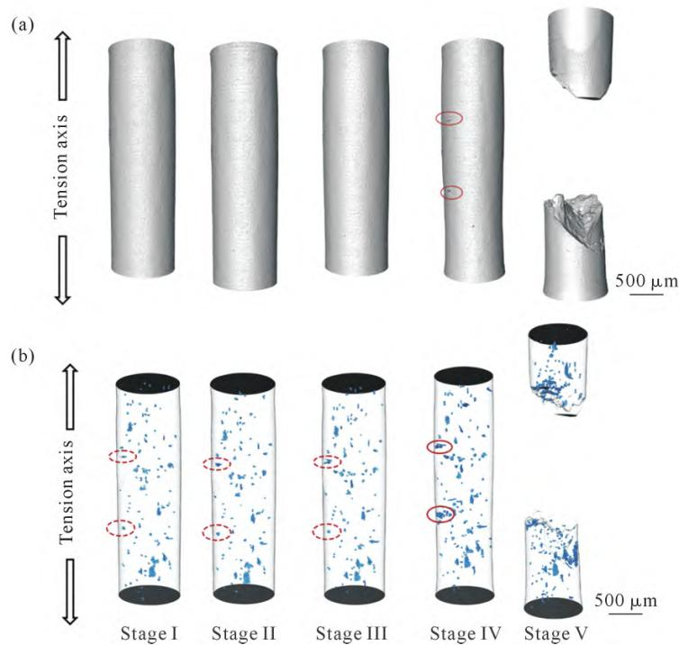
图 11 X-CT 表征 L-PBF 成型 K418 在高温拉伸过程中 5 个阶段的表面与内部缺陷演变:(a)外观图;(b)三维显微结构<sup>[90]</sup>
