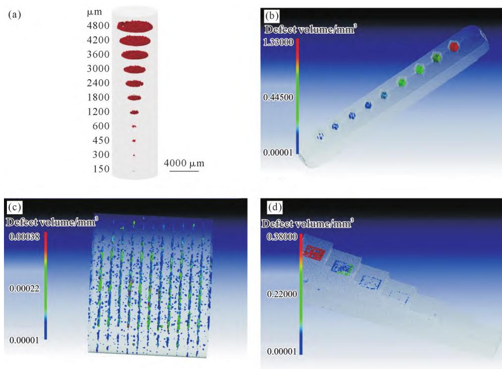
图 5 人孔内置孔隙:(a) 圆币型; (b) 体块型; (c) 等厚片状; (d) 不等厚片状<sup>[30, 64]</sup>
