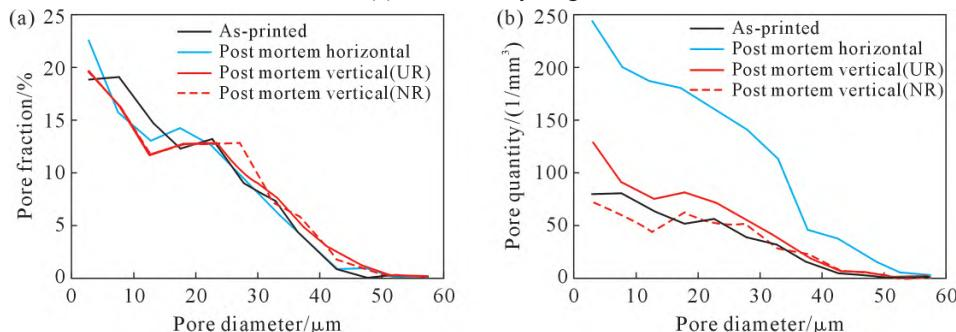
图4 X-CT测量数据:(a) 孔隙分布;(b) 单位体积缺陷数量(UR 和 NR 分别代表拉伸后样品的均匀区域和颈缩区域)<sup>[60]</sup>
