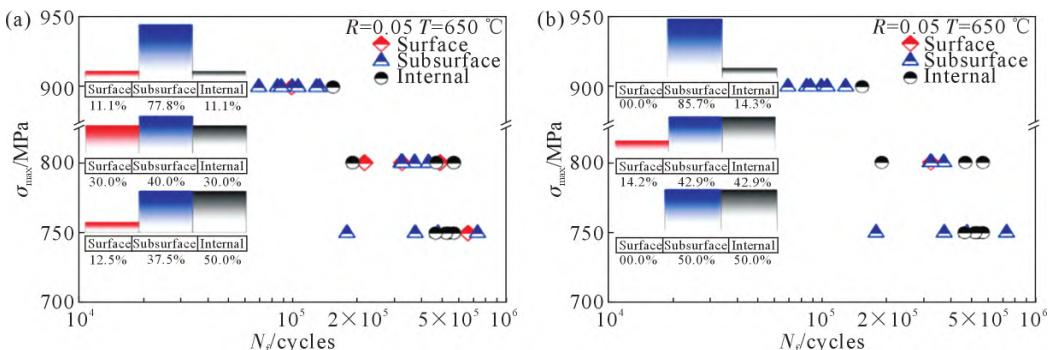
图1 L-PBF镍基高温合金疲劳试样疲劳裂纹起裂位置分布:(a)小平面与缺陷萌生;(b)缺陷萌生<sup>[48]</sup>
