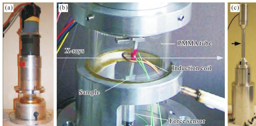
图 7 原位装置:(a) 同步辐射原位单轴拉伸和压缩机;(b) 原位拉伸机 PMMA 管放大图;(c) 实验室原位拉伸机<sup>[72]</sup>
