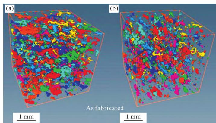
图3 试件沿垂直与水平方向的X-CT三维孔隙分布:(a) 垂直方向;(b) 水平方向<sup>[59]</sup>
