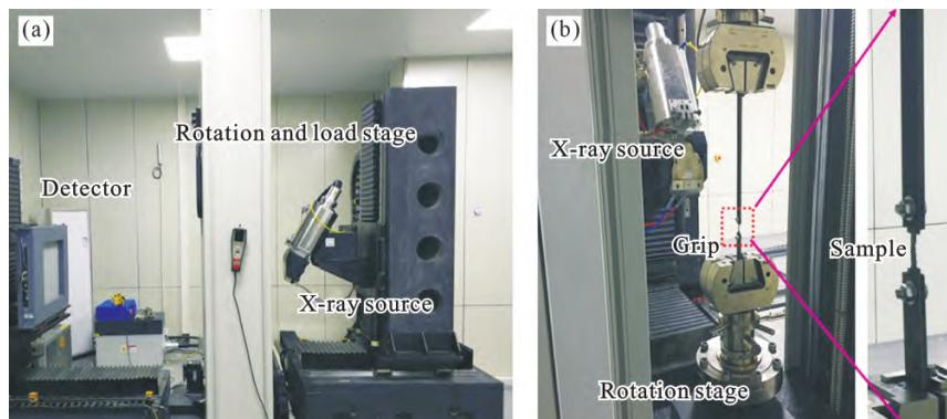
图 8 原位拉伸装置:(a) 原位拉伸断层扫描的实验装置;(b) 样品置物台<sup>[86]</sup>
