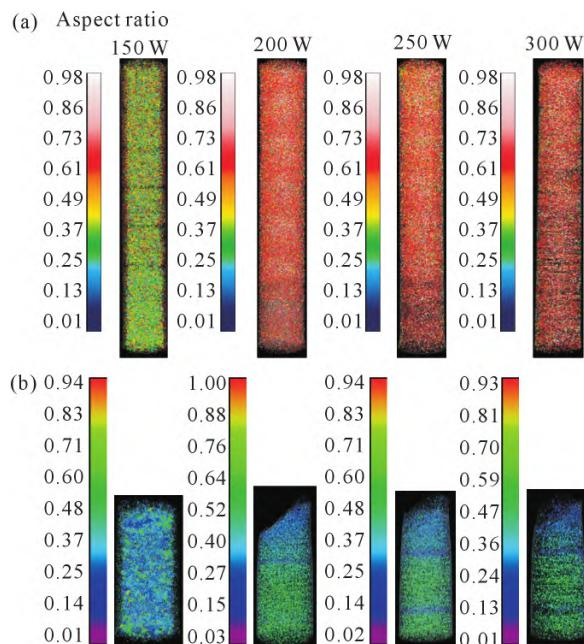
图 6 不同工艺参数下 Inconel 625 的缺陷长径比三维 X-CT:
