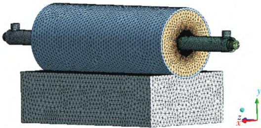
图4 连铸区有限元网格划分结果
