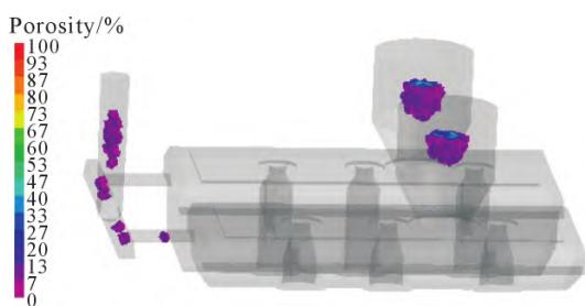
图 12 T 形高锰钢衬板孔隙率分布云图
