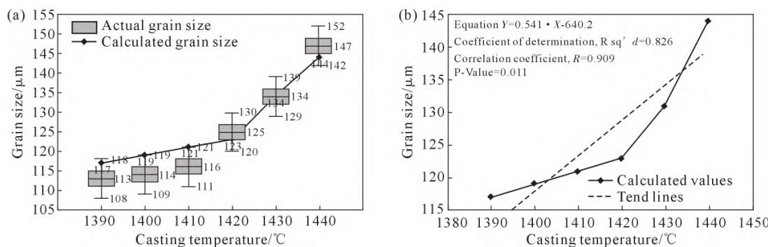
图3 晶粒尺寸随温度的变化:(a) 奥氏体晶粒的计算尺寸与实际尺寸对比;(b) 晶粒尺寸计算值的近似值<sup>[21]</sup>
