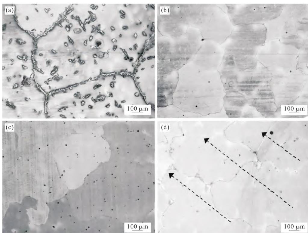
图 5 两种工艺铸造下高锰钢衬板典型金相组织:(a) 普通砂型铸态;(b) 普通砂型热处理态;(c) 覆砂金属型铸态;(d) 覆砂金属型热处理态<sup>[27]</sup>
