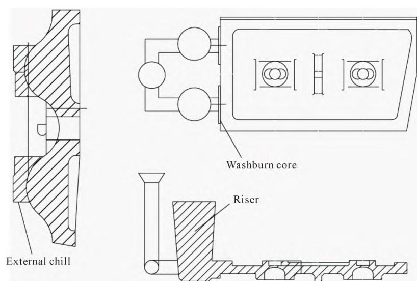
图1 工艺优化方案<sup>[16]</sup>Fig.1 Improved casting process<sup>[16]</sup>
