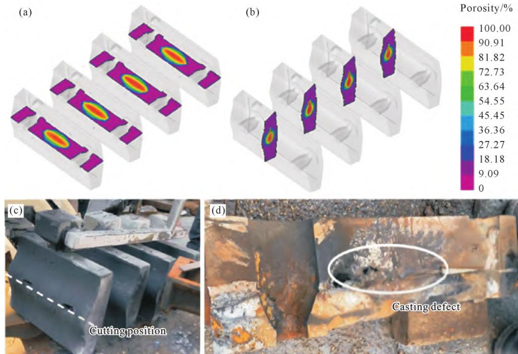
图9 工艺C 仿真与试制生产结果:(a) 缩孔缺陷预测,XY 截面;(b) 缩孔缺陷预测,XZ 截面;(c) 实际铸件;(d) 心部缺陷<sup>[37]</sup>
