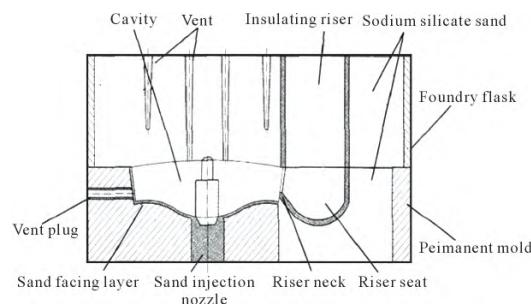
图 4 高锰钢衬板膜砂金属型铸造工艺示意图<sup>[27]</sup>
