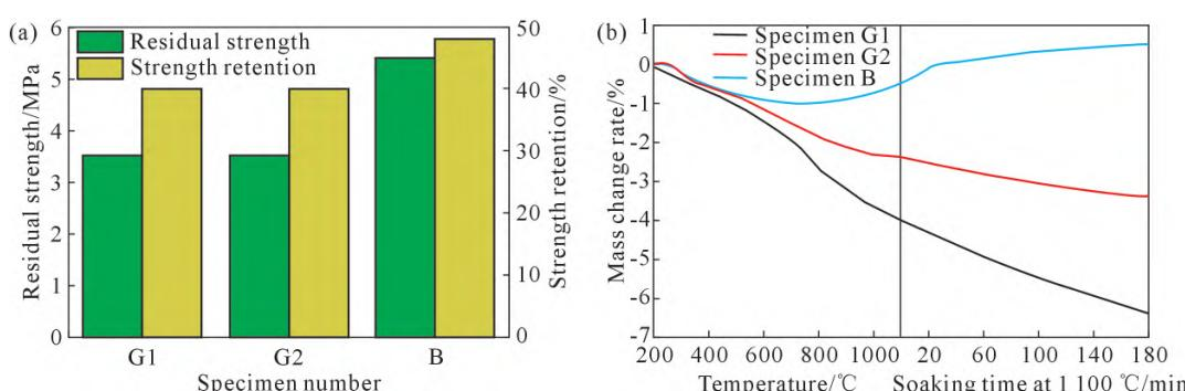
图 7 3 种涂料性能对比:(a) 不同试样残余强度和强度保持率;(b) 不同试样氧化过程中的氧化质量变化曲线<sup>[32]</sup>
