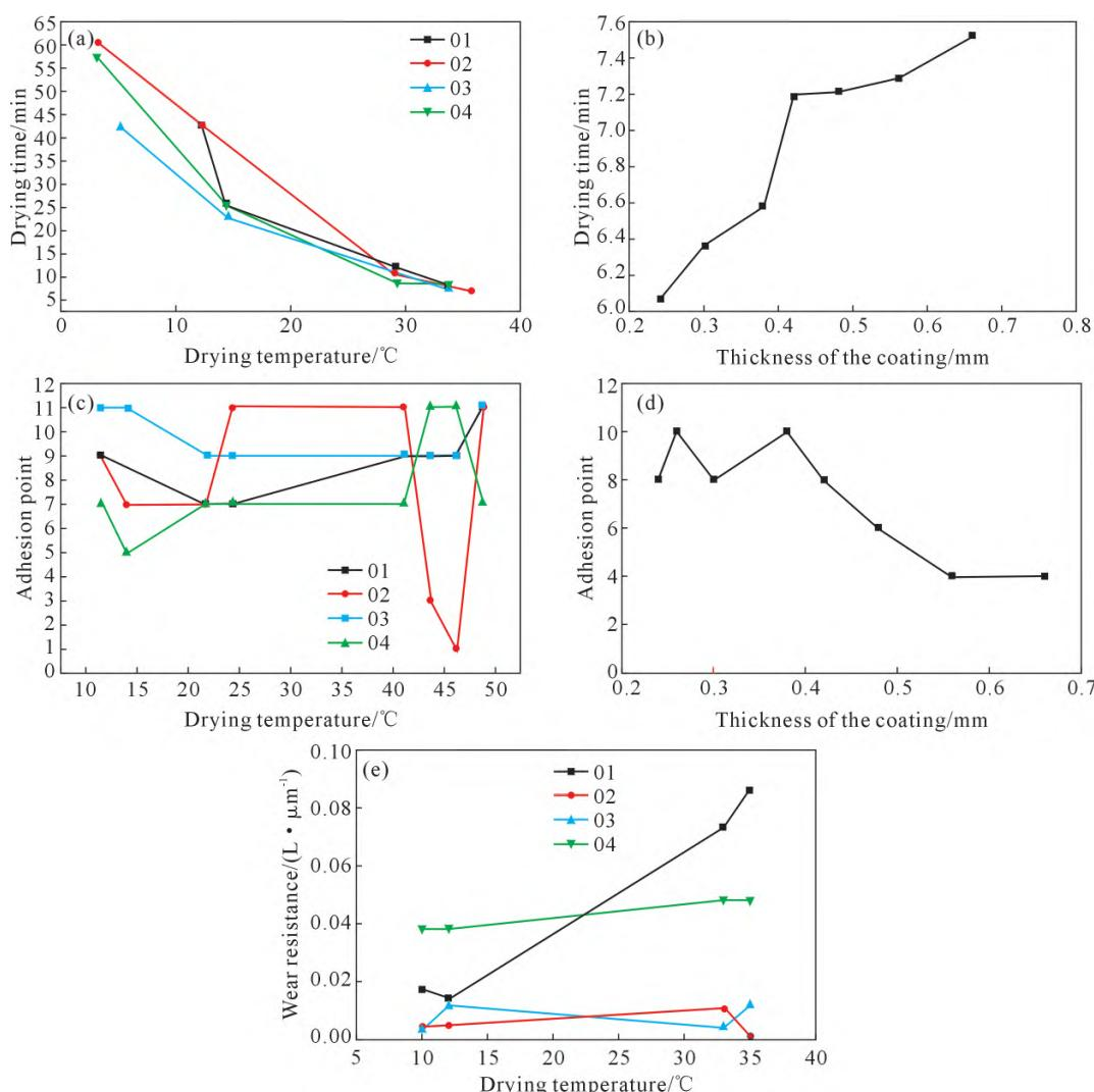
图 13 不同因素对涂料影响关系:(a) 不同干燥温度下涂料干燥时间;(b) 不同厚度下涂料干燥时间;(c) 不同干燥温度下涂料附着点数;(d) 不同厚度下涂料附着点数;(e) 不同干燥温度下涂料耐磨损性<sup>[52]</sup>
