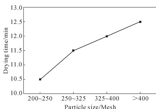
图 14 耐火骨料粒径对涂料干燥性能的影响<sup>[53]</sup>
