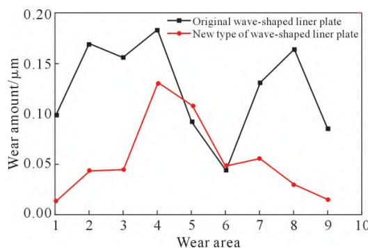
图 16 波形衬板磨损<sup>[57]</sup>
