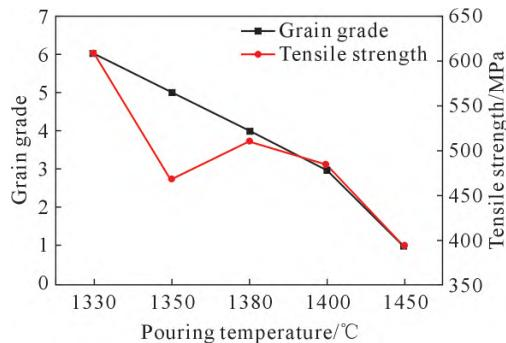
图2 浇注温度对晶粒度和力学性能的影响<sup>[20]</sup>
