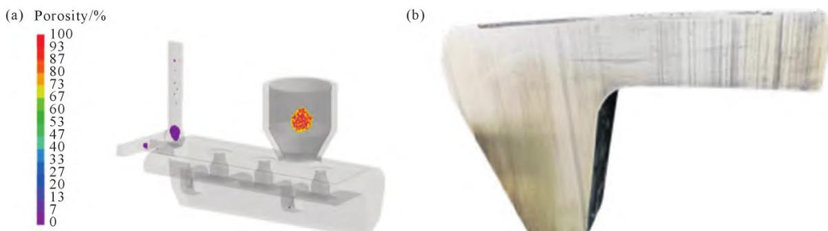
图18 优化铸造工艺后孔隙分布与铸件截面:(a)衬板孔隙分布;(b)铸件截面<sup>[64]</sup>
