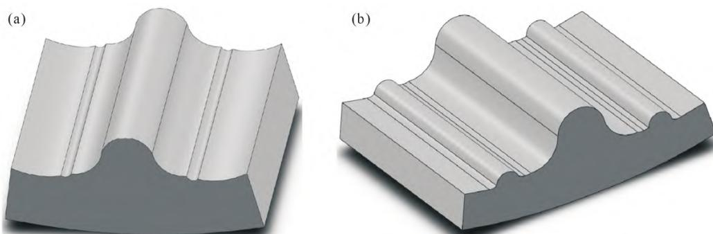
图 15 改进前后波形衬板形状:(a) 原始波形衬板;(b) 新型波形衬板<sup>[57]</sup>
