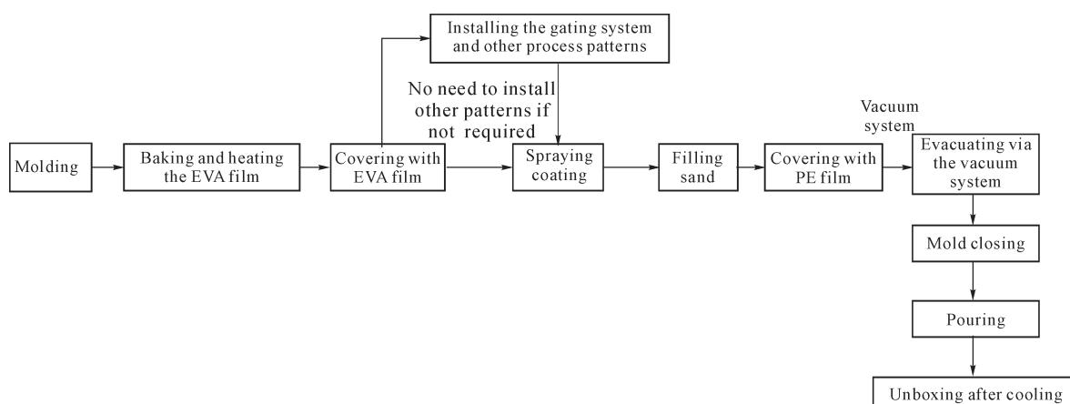
图 11 V 法铸造生产工艺基本流程
