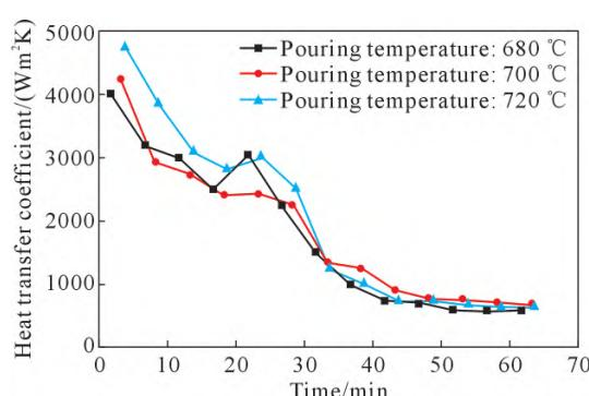
图 6 不同浇注温度下界面换热系数对比<sup>[29]</sup>
