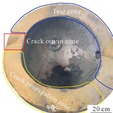
图 3 空心磨球开裂宏观形貌
