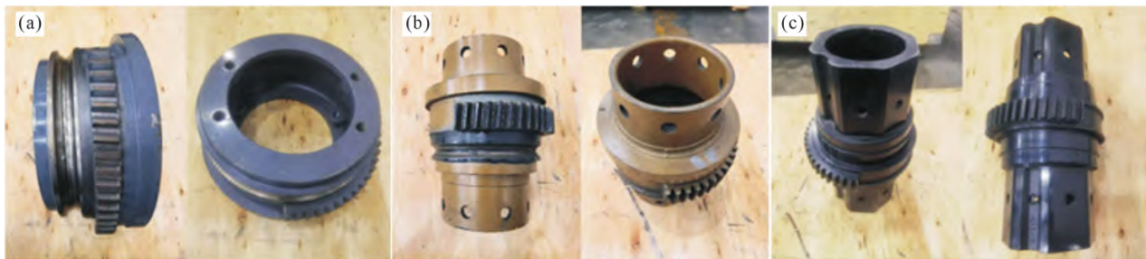
图 4 加工好的用于太阳能光伏跟踪器减速器 3 种不同型号的 ADI 齿轮(江苏昌坚铸造厂提供):(a) 型号 1;(b) 型号 2;(c) 型号 3
