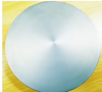
图 6 TC18 棒材低倍组织 Fig.6 Macrostructure of the TC18 bar
