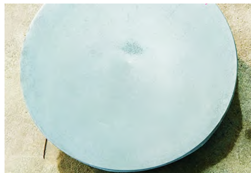
图 2 TC18 棒材低倍组织 Fig.2 Macrostructure of the TC18 bar
