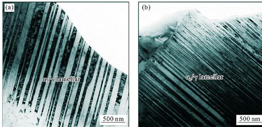
图 6 TNM 合金板材中片层组织的 TEM 像: (a) 炉冷; (b) 空冷
