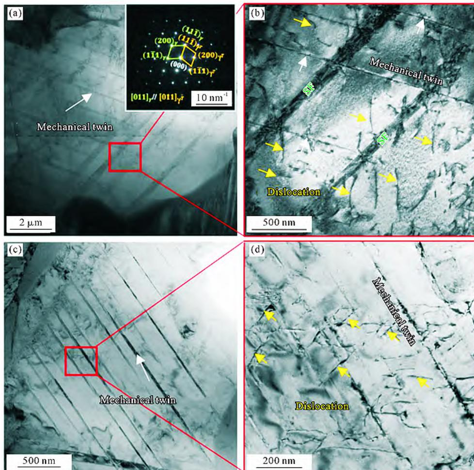
图 7 炉冷板材室温拉伸后的 TEM 像: (a, c) 机械孪晶; (b, d) 机械孪晶与位错交互
