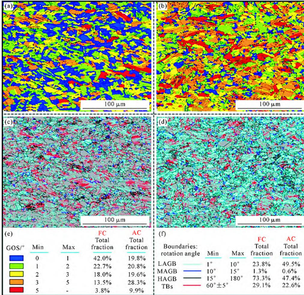
图4 炉冷和空冷板材的GOS图以及晶界分布图:(a, b)炉冷和空冷板材的GOS图;(c, d)炉冷和空冷板材的带对比图叠加晶界;(e)GOS值;(f)晶界分数
