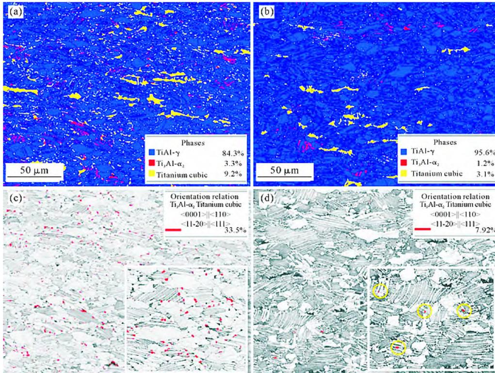
图 3 不同冷却方式下 TNM 合金板材的 EBSD 分析:(a, b) 炉冷和空冷板材的相分布;(c, d) 炉冷和空冷板材的带对比图叠加取向关系
