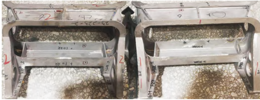
图9 热等静压后 X 光探伤标识缺陷位置
