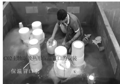
图9 安装冒口保温套
