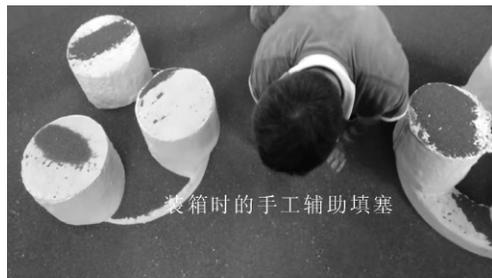
图8 填砂埋型时不宜进砂的位置要手工辅助
