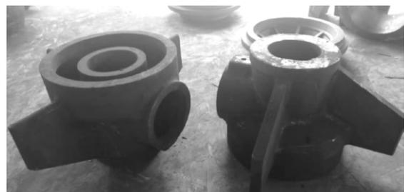
图10 清理后的铸件
