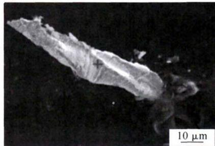
图2 粗粒片状纯金的SEM形貌
