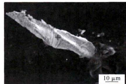
图2 粗粒片状纯金的SEM形貌
