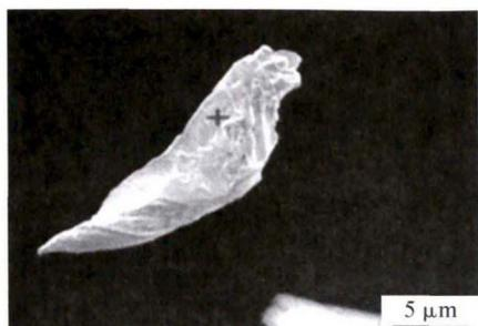
图3 细粒片状纯金的SEM形貌
