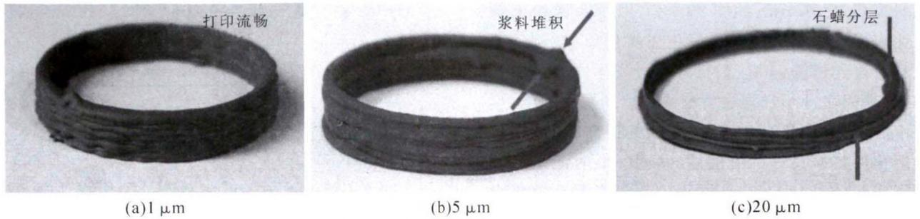
图2 不同粒径的铜浆料成形效果图
