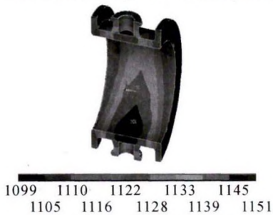
图 3 14 663 s 时温度场分布 Fig.3 The 14 663 s Temperature Field Distribution
