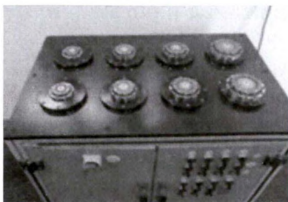
图 4 8 工位轴承试验台 Fig.4 8 station bearing test stand
