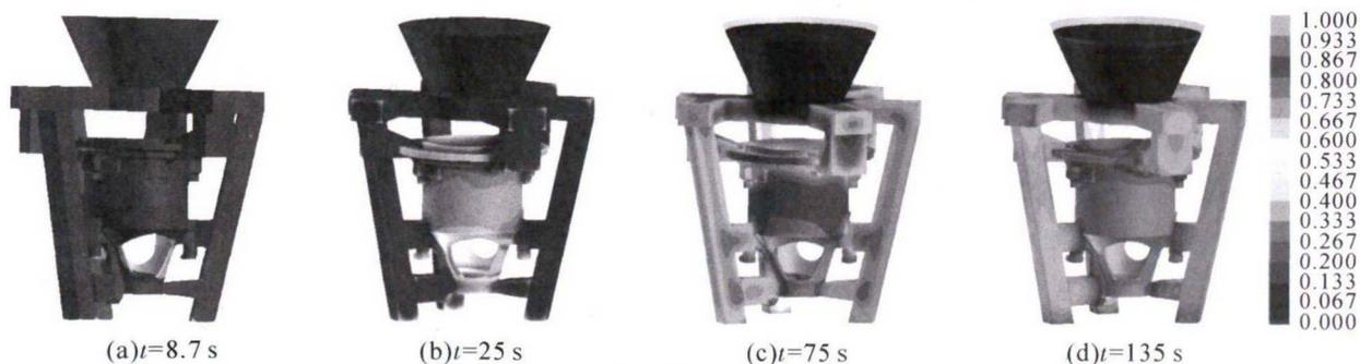
图4 铸件凝固过程模拟
