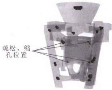
图 5 铸件疏松缩孔预测分布图
