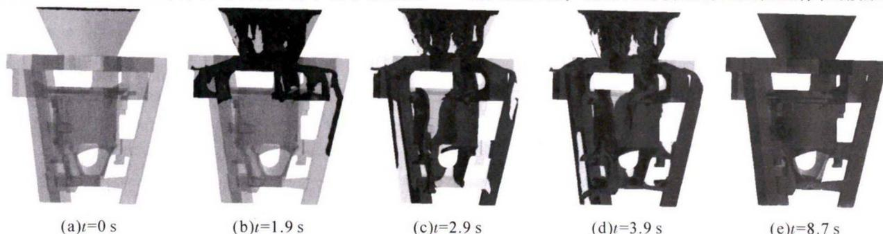
图3 铸件充型过程模拟
