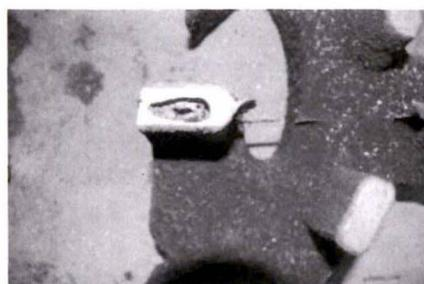
图 10 铸件气孔缺陷
