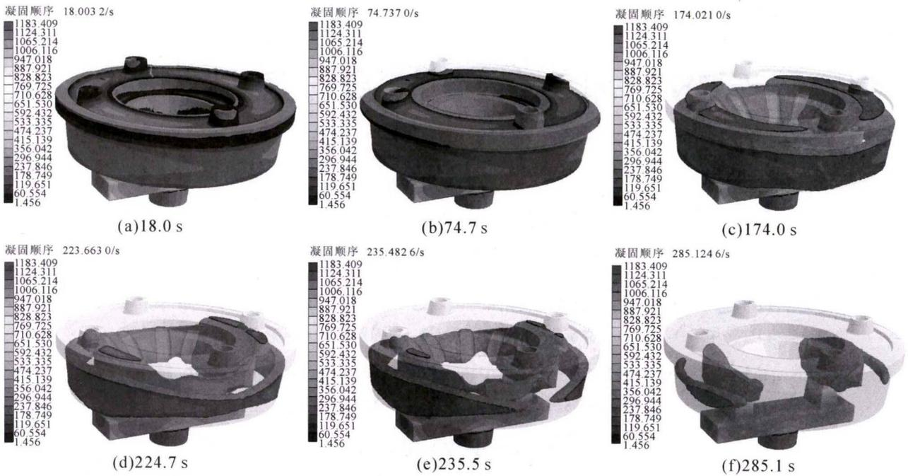
图 5 模拟液相凝固过程
