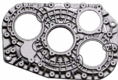
图 3 开裂区域分布图 Fig.3 Crack zone distribution
