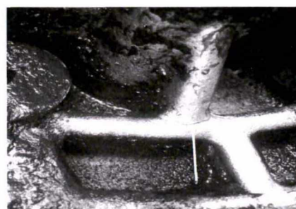
(b)c区域裂纹
