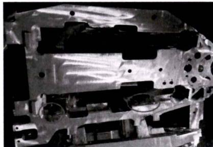
图 1 平台零件铸造缺陷位置
