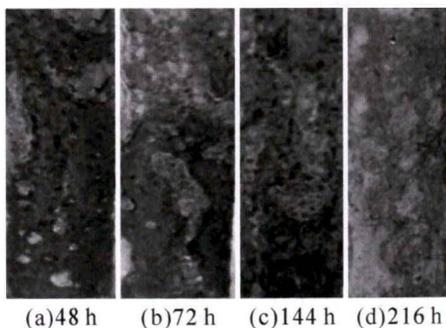
图 2 1 号钢筋腐蚀表面形貌
