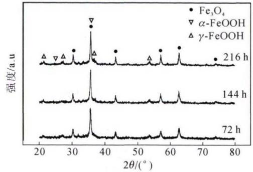
图6 2号钢筋 XRD 分析结果
