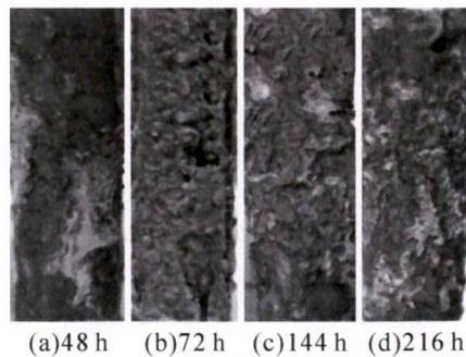
图 3 2 号钢筋腐蚀表面形貌
