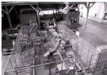
图1 某企业冷芯盒精密组芯造型自动化生产线
