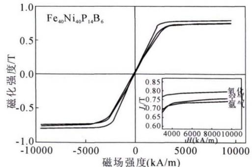
图3 不同气氛下制备的 Fe<sub>40</sub>Ni<sub>40</sub>P<sub>14</sub>B<sub>6</sub> 块体非晶态合金棒在室温下的磁滞回线
