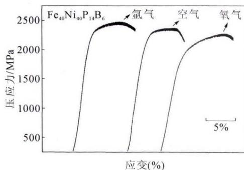
图 4 不同气氛下制备的  $Fe_{40}Ni_{40}P_{14}B_6$  块体非晶态合金棒的常压缩应力-应变曲线
