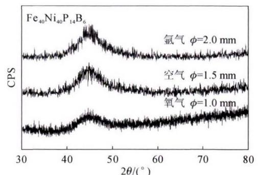
图 1 不同气氛下制备的最大尺寸的 Fe<sub>40</sub>Ni<sub>40</sub>P<sub>14</sub>B<sub>6</sub> 块体非晶态合金棒样品的 XRD 图谱
