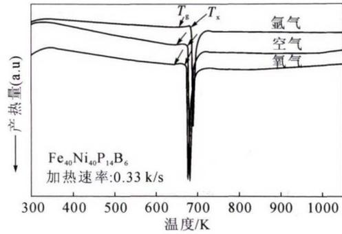
图2 不同气氛下制备的 Fe<sub>40</sub>Ni<sub>40</sub>P<sub>14</sub>B<sub>6</sub> 块体非晶态合金棒在 0.33 K/s 加热速率下的 DSC 扫描曲线
