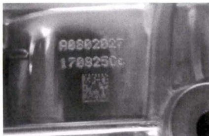
图5 明码及暗码示意图
