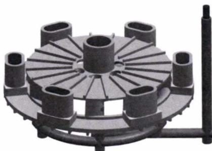
图3 叶轮铸件及浇冒口系统三维模型
