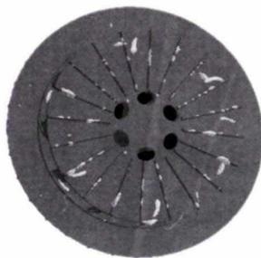
图7 叶轮铸件模拟的缩孔缩松缺陷
