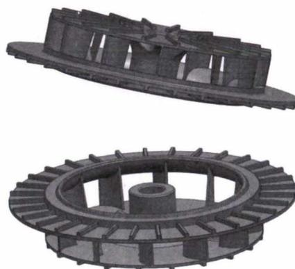
图 1 大型薄壁叶轮三维模型
