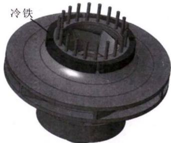
图6 优化后的铸造方案II,增加了冷铁
