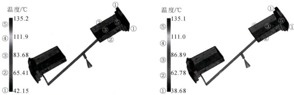
图 8 默认值下的零件温度(左)与模具温度(右)
