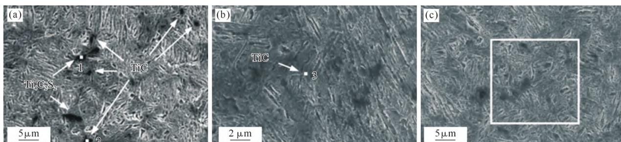
图1 不同Ti含量的实验钢中析出物的形态分析:(a) 0.1%Ti, (b) 0.2%Ti, (c) 0.4%Ti<sup>[14]</sup>
