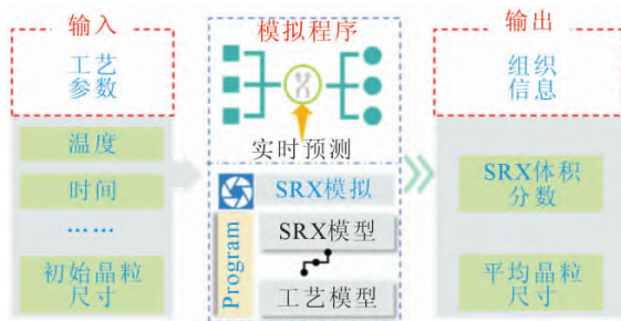
图7 产品热处理工艺中组织预测实现流程 (SRX: 静态再结晶)
