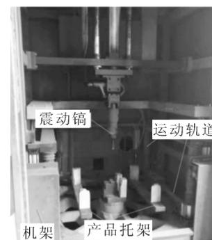
图1 落砂机的内部结构图
