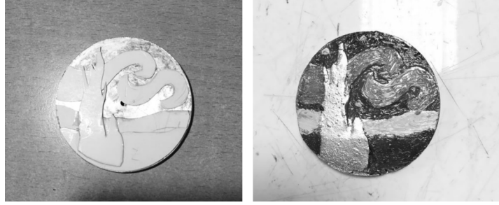
图 1 纪念币模板以及砂型铸造浇注所得实物
