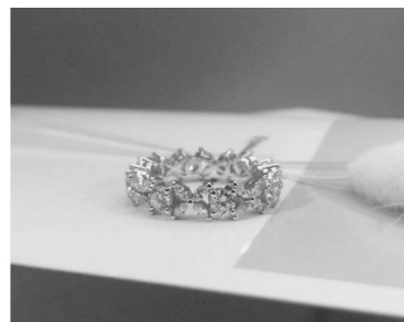
图 3 学生设计的三维模型以及精密铸造所得实物
