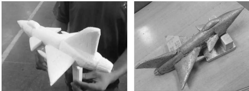
图 2 学生制作的泡沫模型以及消失模铸造所得实物
