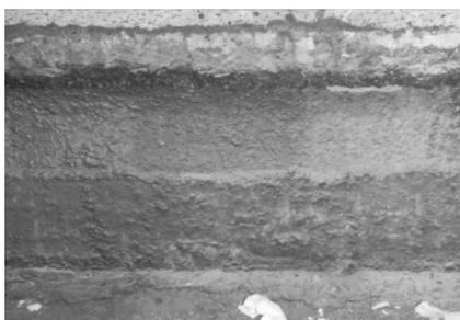
图 3 中间包渣线部位使用 13 h 后形貌
