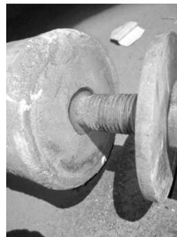
图 4 塞棒螺杆凸台
