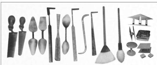
图中从左至右依次为:1.刮刀 2.尖刮刀 3.压勺 4.单齐压勺 5.提钩 6.单头钢批 7.秋叶 8.单开提钩 9.法兰钩 10.钢批钩 11.掸笔、扫笔 12.圆水笔 13.铸顶
