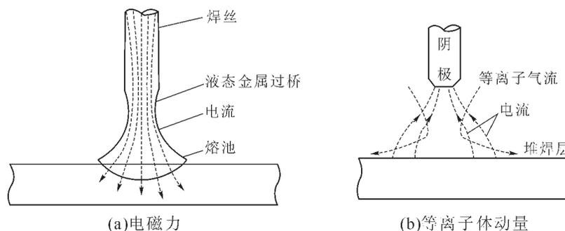
图 3 熔池受力示意图
