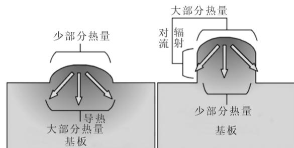
图 4 打印件散热示意图<sup>[28]</sup>
