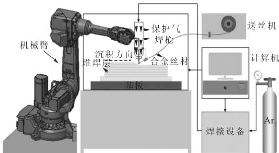
图 1 GTAW 或 PAW 智能化 WAAM 示意图
