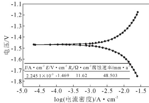
图9 SLM-AZ91D 动电位极化曲线
