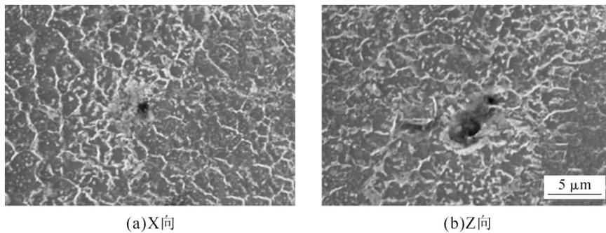
图 4 激光选区熔化 AZ91D 镁合金中的气孔缺陷
