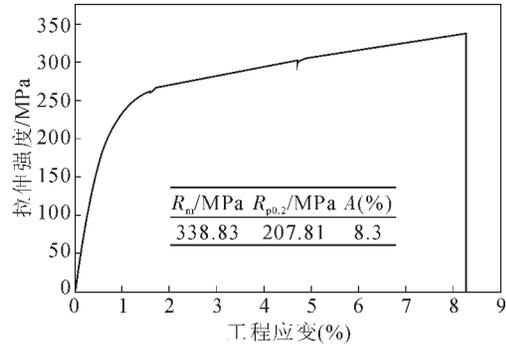
图 6 SLM-AZ91D 拉伸曲线
