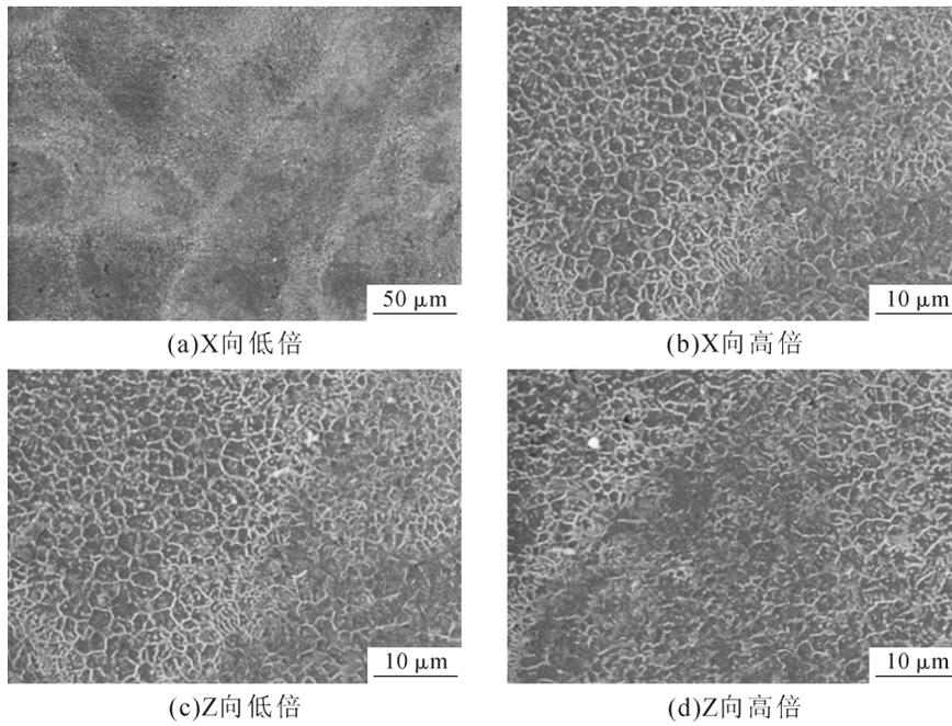
图 2 SLM-AZ91D SEM 形貌
