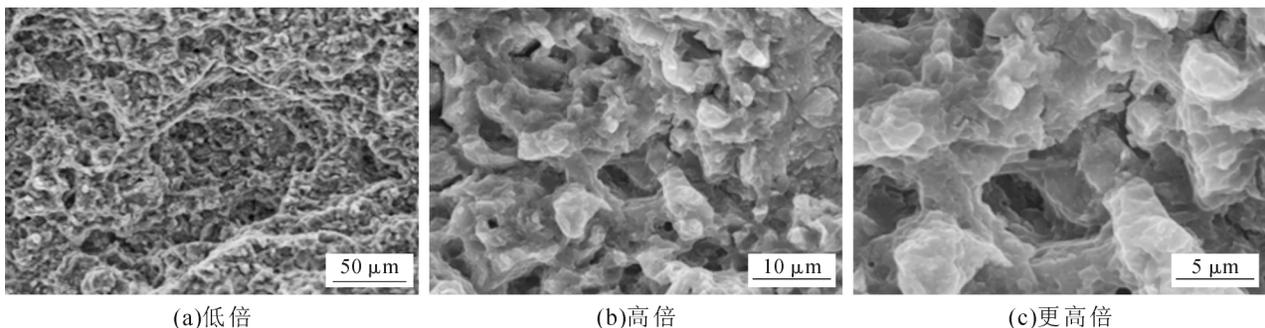
图 7 SLM-AZ91D 镁合金拉伸断口扫描形貌
