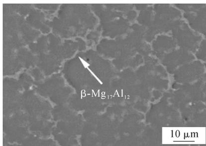
图 3 铸态 AZ91D SEM 形貌
