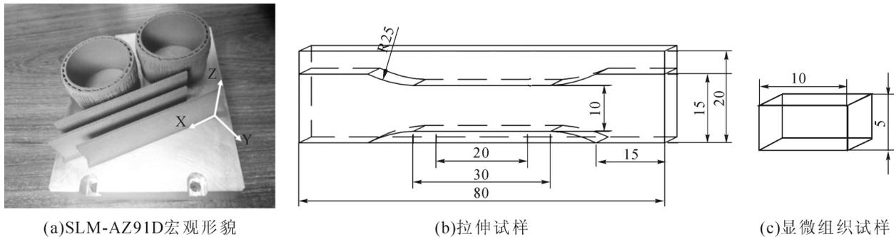
图 1 SLM-AZ91D 零件及试样取样位置与尺寸
